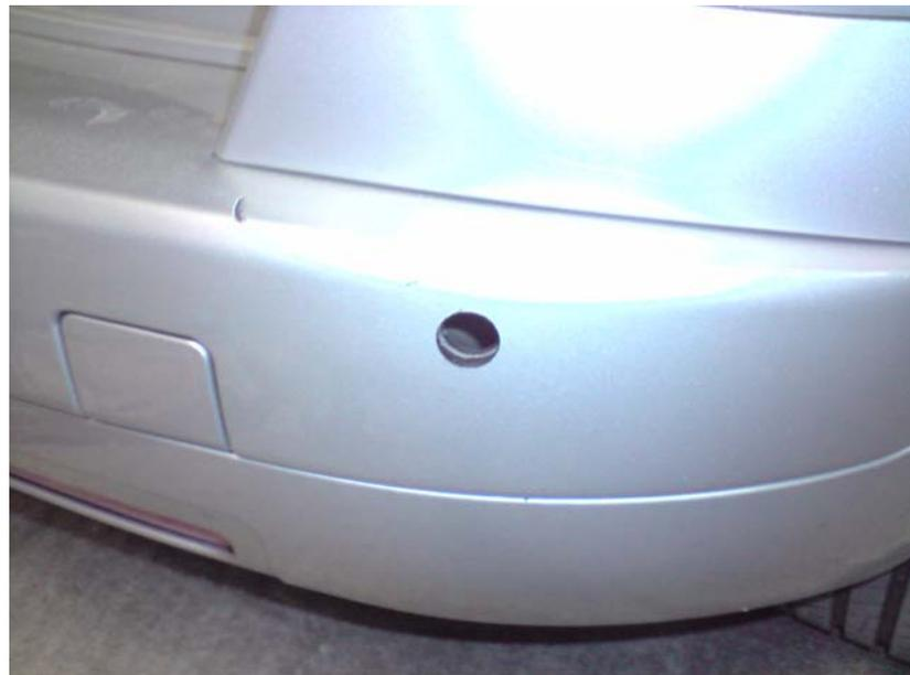
Une fois percé, placer les radars dans les trous et passer les câbles derrière le renfort derrière le par choc.
