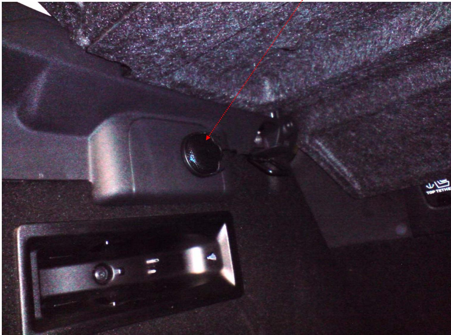
Une fois tout monté il faut brancher le câble sur un + des feux de recul et un autre sur la masse
